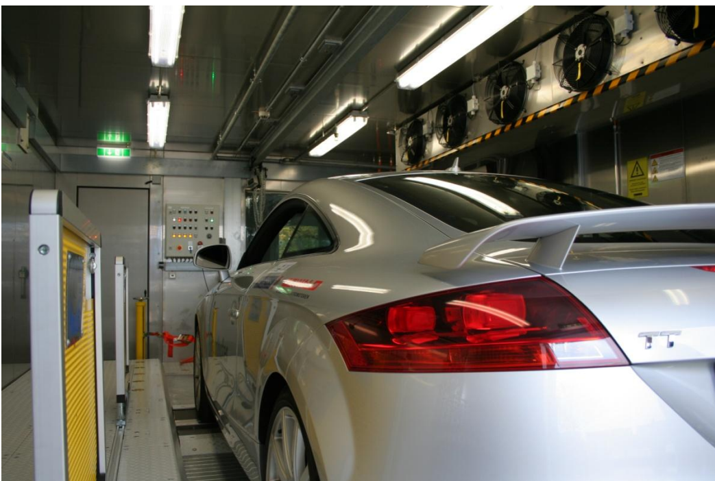
Das TT-Hybridfahrzeug des IISB im Elektrofahrzeug-Testzentrum des Instituts. Auch Industriepartner können die umfassenden Prüfeinrichtungen nutzen.
