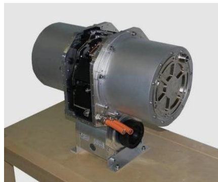
Achsantriebseinheit – hier als Ausstellungsobjekt mit geöffneter Leistungselektronik.
