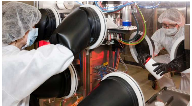
Mitarbeiter des Fraunhofer THM in Freiberg bereiten einen Kristallzüchtungsversuch in der neuen HVPE-GaN-Anlage vor. Bild: Fraunhofer THM
