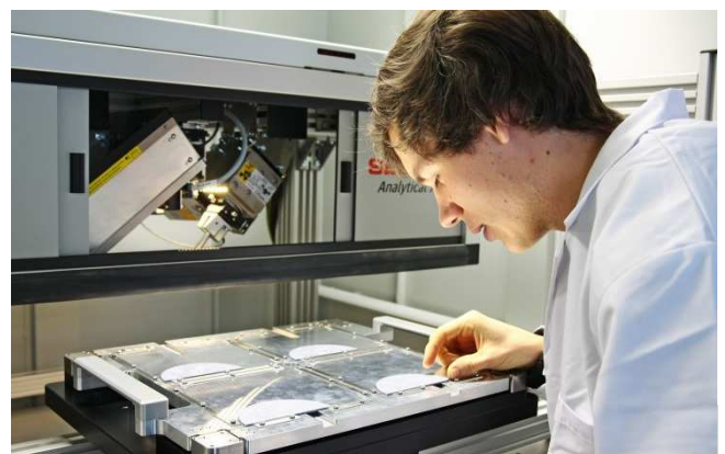
EMRS-Preisträger Toni Lehmann vom THM Freiberg bestückt seinen Laue-Scanner mit Forschungsproben von Solarwafern. Mit dem Laue-Scanner lassen sich die Kornorientierungen in multikristallinen Siliziumwafern detektieren. Bild: Fraunhofer THM
