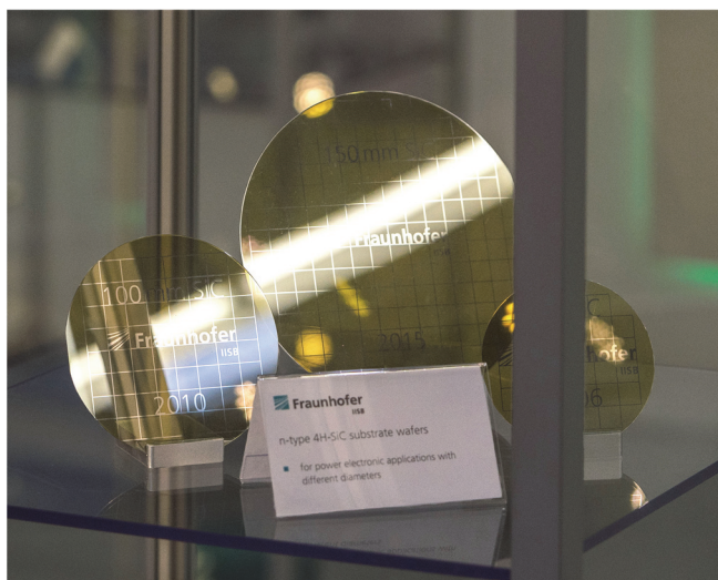
Die zeitliche Entwicklung der Größen von Siliziumkarbid-Wafern über die Jahre wurde anhand dieses Exponats anschaulich dargestellt. Foto: Amelie Schardt / IISB
